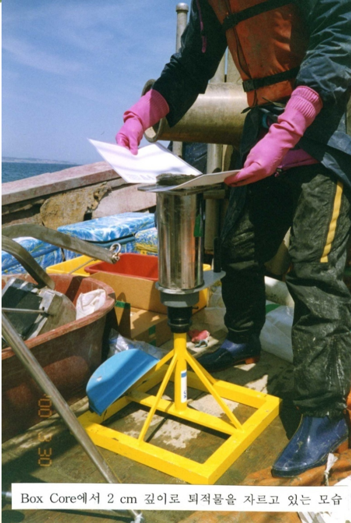
Gravity Core를 이용해서 퇴적물을 Sampling 한 모습
